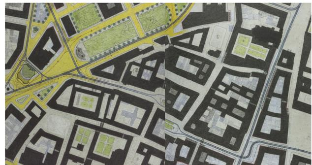
Abb.9: detaillierter Sanierungsplanungsauszug für den Wiederaufbau im nördlichen Teil des Kreuzviertels: schwarz-Bebauungsvorschlag, hellgrau-Vorkriegsbebauung, eingekreuzt-Fußgängerdurchgänge/arkaden
